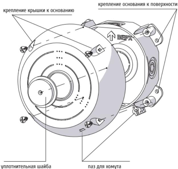
2) Закрепите основание монтажной коробки на поверхность, используя дюбели и саморезы.
