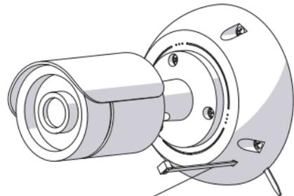
4) Соедините крышку с основанием таким образом, чтобы отверстия для хомута совпали. Проденьте нейлоновый хомут в паз и не полностью затяните его.
